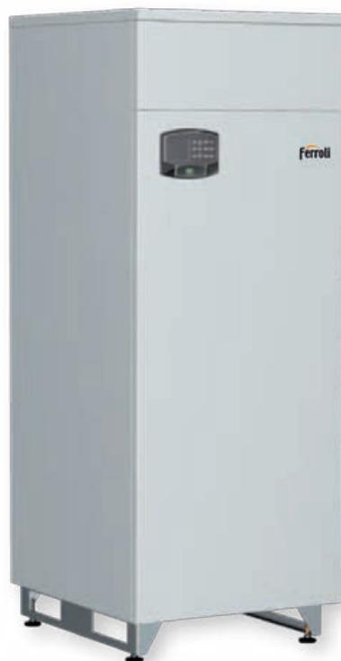
Generatore termico a condensazione a sviluppo verticale e basso carico termico, certificato INAIL per l'installazione in batteria. Completo di bruciatore premix a bassissime emissioni inquinanti con passaggio dei fumi diretto attraverso lo scambiatore. Caldaia ad elevato contenuto d'acqua e bassissime perdite di carico lato acqua. Gamma composta da quattro modelli con potenze termiche da 70 kW a 320 kW rispettivamente.
